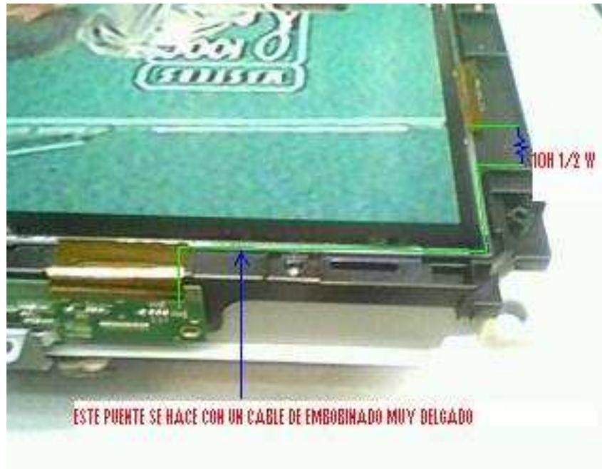
Se recomienda hacer el puente con alambre de cobre para embobinar de un calibre fino, y en uno de sus extremos colocar la resistencia de 10 ohmios.
