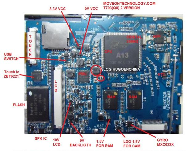
REVISAR RESISTENCIA Y BOBINA MARCADOS EN CIRCULO ROJO EN CASO DE PROBLEMAS DE CARGA
